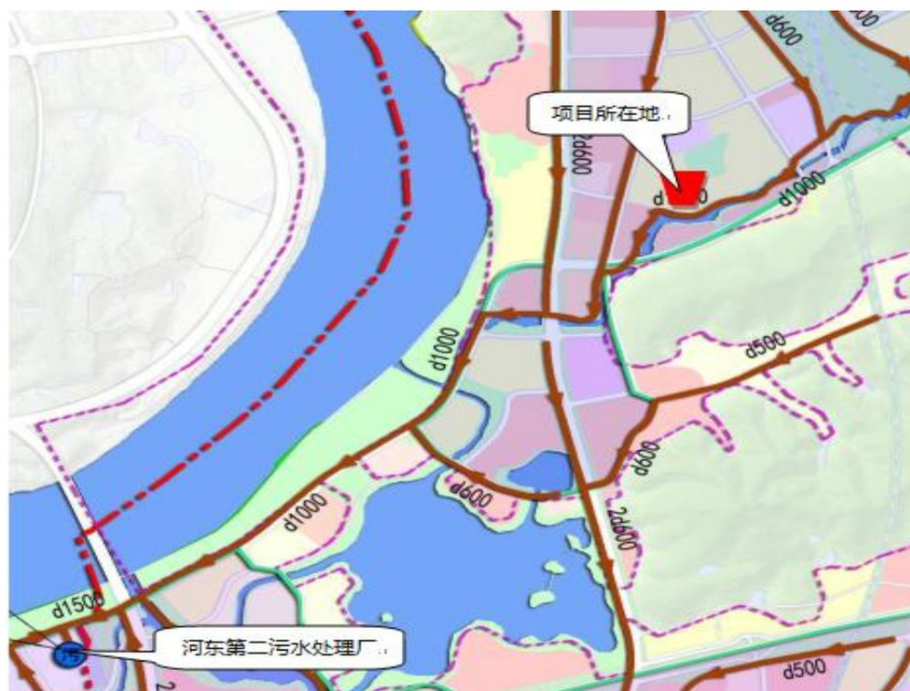
图 1-3 项目废水排放走向示意图
